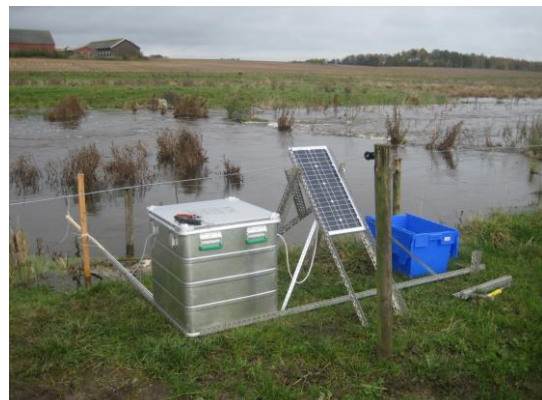
Solcellsdriven automatisk vattenprovtagare vid Hjularödsvåtmarkens utlopp.
