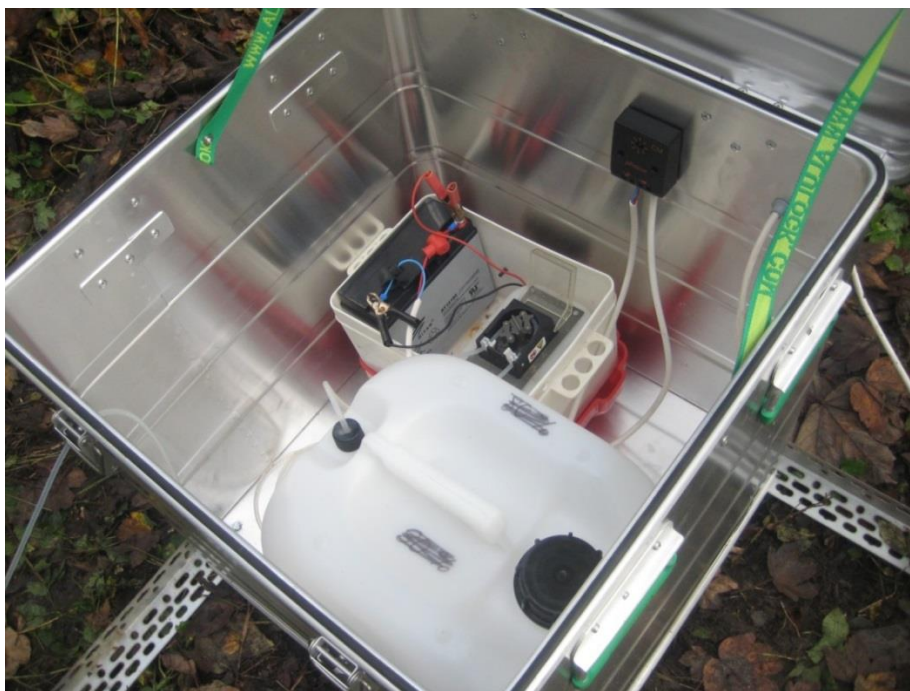
Figur 5. Provtagaren, en 12 V Watson Marlow slangpump, monterad med laddningsregulator, batteri och 25-liters uppsamlingsdunk. Batteriet laddas från en 25W solpanel (se omslagsbild samt figur 9, provtagaren vid våtmarkens utlopp).
