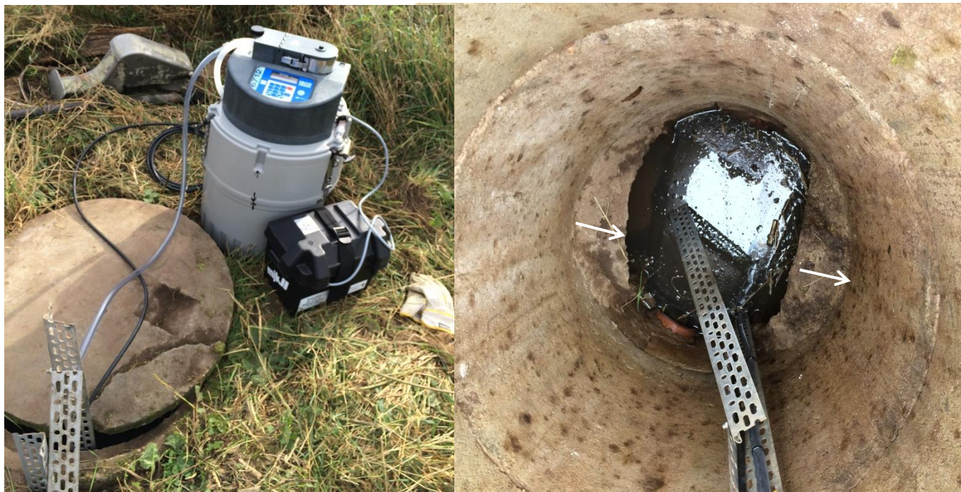
Figur 2. Provtagaren vid inloppet. Tryckgivare (för nivåmätning) och provtagnings slang är monterade på en vinkelprofil för stabilt läge.
