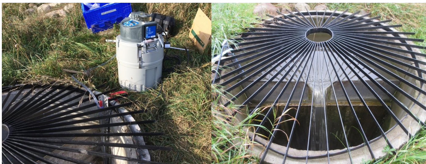
Figur 3. Provtagning på utloppssidan. Tryckgivare och provslang monterade med vinkelprofil på överfallets uppströmssida.
