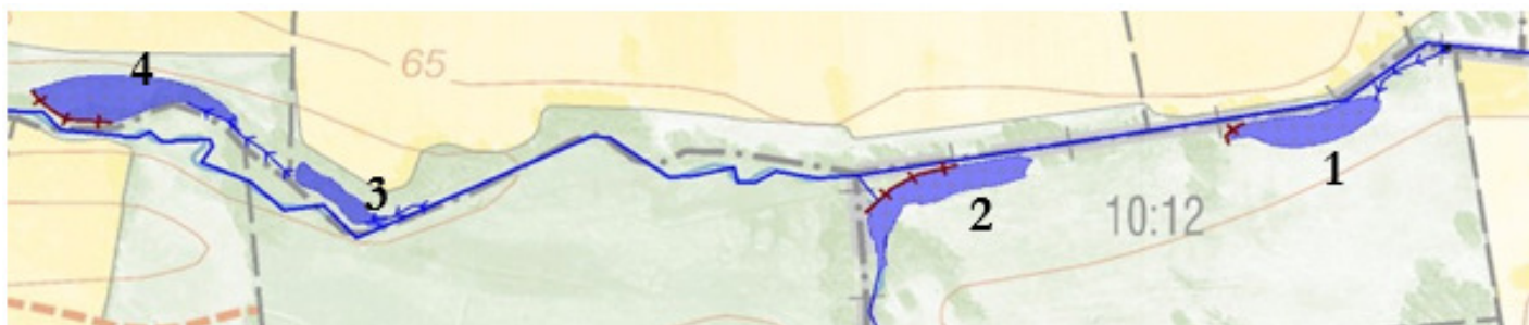
Figur 9 Översikt över åtgärds lägen 1-4. På bilden ses maximal utbredning av översvämningssområden, läge för plankdämnen samt sträckor för inledning av vatten.
