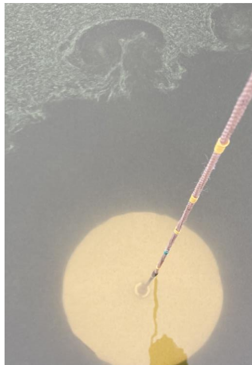
Figur 6. Foto från provtagning av siktdjup med siktskiva. Foto: SGS.
