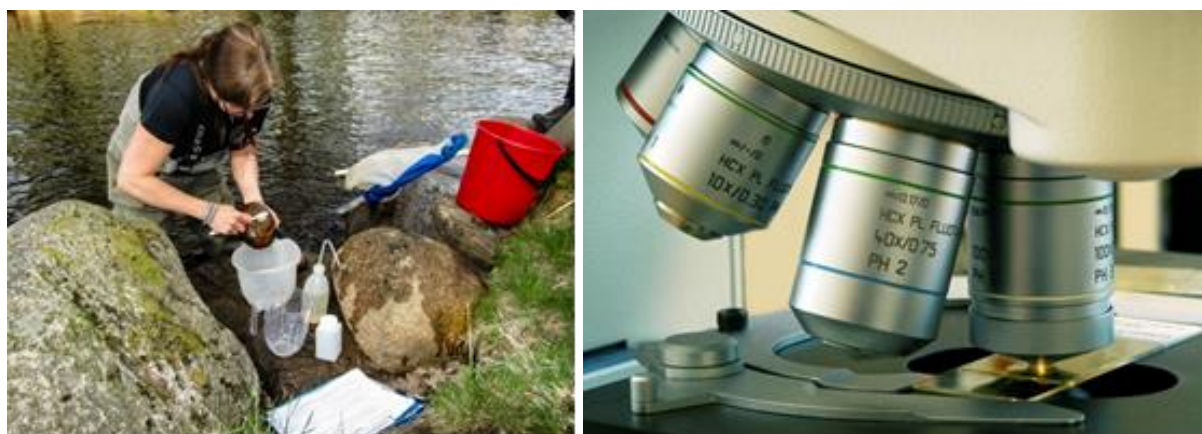
Figur 16. Provtagning av kiselalger görs i första hand genom borstning av stenar varefter kiselalgspreparat framställs och analyseras i ljusmikroskop med 1000 gångers förstoring (objektiv 100x), © Medins Havs och Vattenkon-sulter AB.
