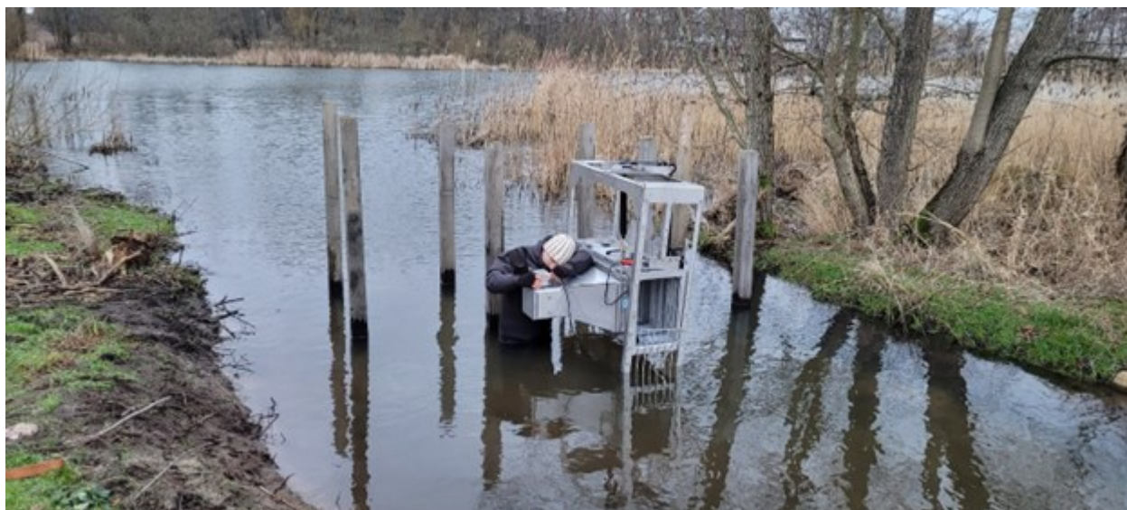
Fiskräknare. Installation av fiskräknaren vid utloppet till Lilla Torpsbäckens våtmarkssystem vintervåren 2025. Foto: Ekologigruppen.
